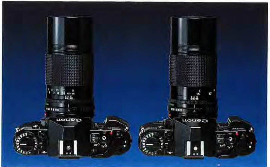
L'emploi du système de mise au point par déplacement du groupe arrière, comme c'est le cas dans le nouveau FD 200 mm f/4. À gauche l'objectif à l'infini. À droite, il est réglé pour la distance de mise au point minimale. La longueur du barillet n'a pas changé.
