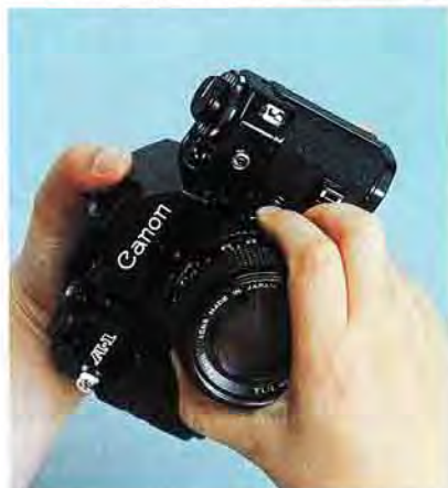
Montage, opération 1. Aligner la saillie rouge de l'objectif avec le point rouge du boîtier.
