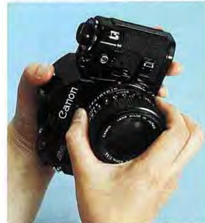
Dépose: Appuyer sur le bouton de déblocage d'objectif et tourner le barillet d'un cinquième de tour dans le sens inverse des aiguilles d'une montre.
