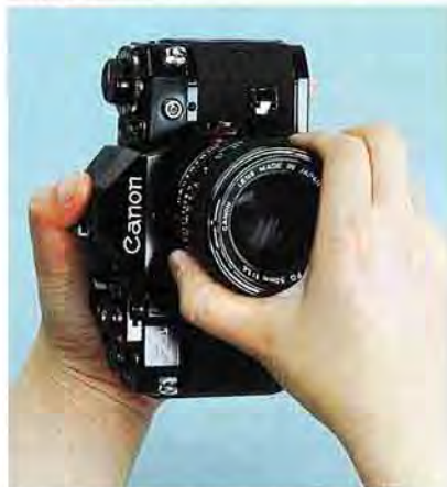
Montage, opération 2. Tourner l'objectif d'un cinquième de tour dans le sens des aiguilles d'une montre jusqu'à percevoir le déclic.
